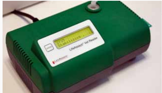
LifeAssays® VetReader - Instrument avsett för den veterinära marknaden anpassat för olika testkit.
